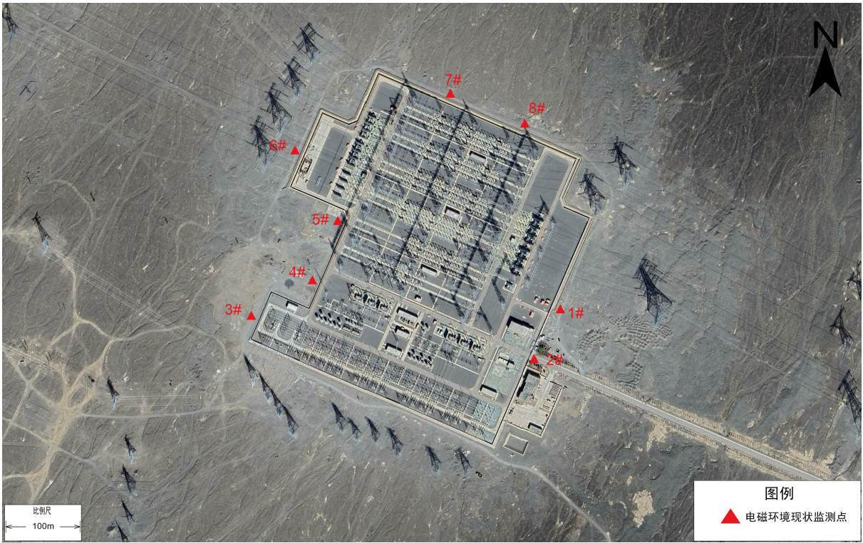
图 4.3-1 哈密 750kV 变电站电磁环境监测布点图
