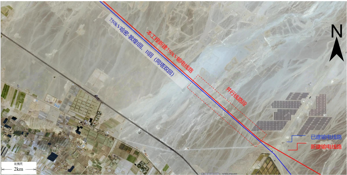
图 3.1.3-12 输电线路与 750kV 哈敦 I、II 线并行情况示意图
