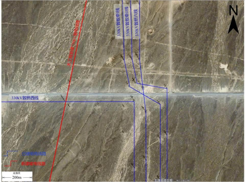
图 3.1.3-8 输电线路与 330kV 敦桥西线交叉跨越情况示意图
