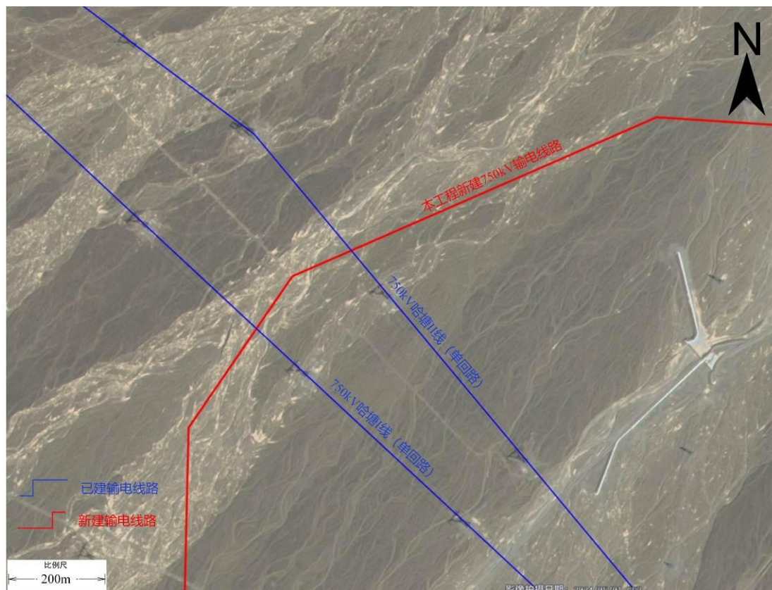
图 3.1.3-4 输电线路与 750kV 哈密—三塘湖 I 回、哈密—三塘湖 II 回线路交叉跨越情况示意图
